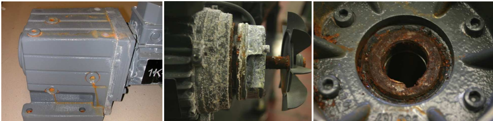
Standardgetriebemotor (ohne besonderen Korrosionsschutz) nach einem Salzsprühnebeltest
